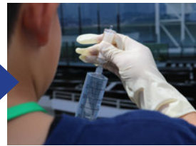
③ 専用のキットで水をろ過DNAをろ紙に附着させる
